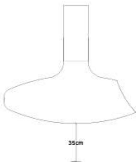
Los productos Ashwood cuentan con un diseño exclusivo y unico. El corte de la boca de fuego está inspirado en una boca de pez dejando así una amplia visión de fuego. La estufa lleva un mecanismo de rotación de 360°, el cual puede ir incluido o dejar la estufa en una sola posición. Los conductos vienen en tramos de 1.5m de largo y se unen unos con otros con tornillos Allen.
